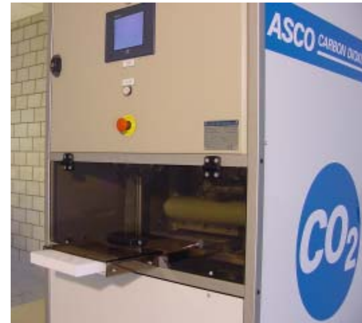
Der flache und horizontale Trockeneis-Ausgang minimiert Trockeneisverluste.
