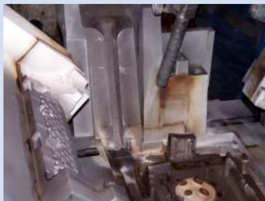
Die Kokillen werden direkt auf den Anlagen gereinigt.
