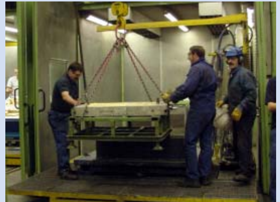
Die Kernkästen werden zur Reinigung in einer Schallschutzkabine vorbereitet.
