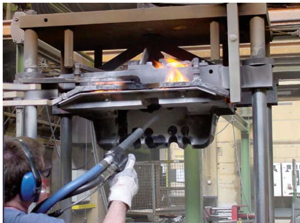
Bild 2: Das Verfahren erlaubt auch die Online-Reinigung einer heißen Kokille.
