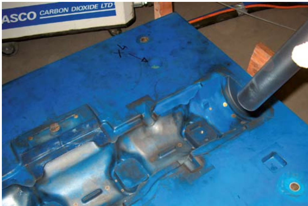
Bild 1: Auch Kernkästen können sehr schonend mit Trockeneis gereinigt werden.
