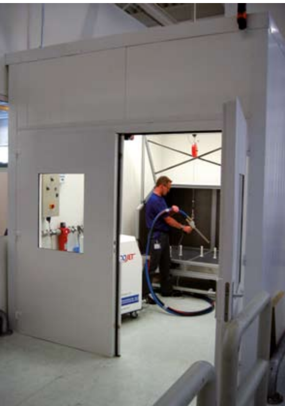
Bild 4: Eine Komplettlösung: Trockeneis-Strahlanlage mit Schallschutzkabine
