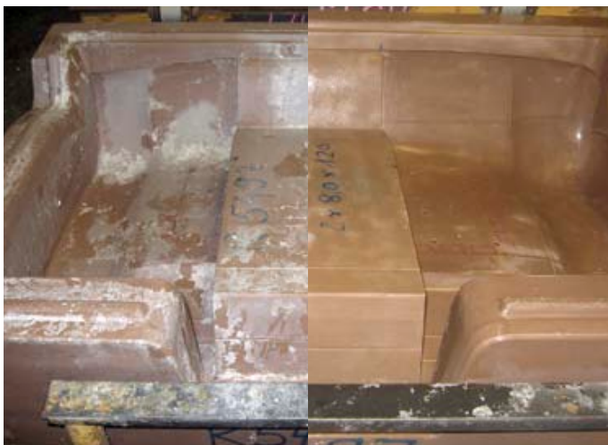
PU-Schäumwerkzeuge vor und nach der Reinigung mit Trockeneis
