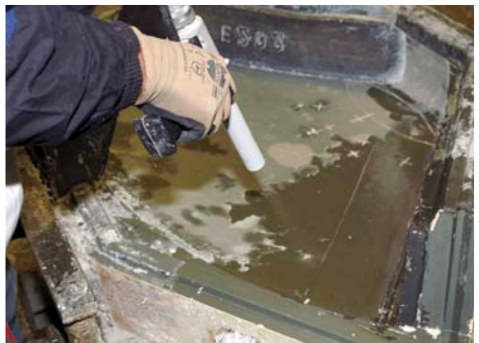
Die schonende Trockeneis-Strahltechnik verringert den Werkzeugverschleiß deutlich
