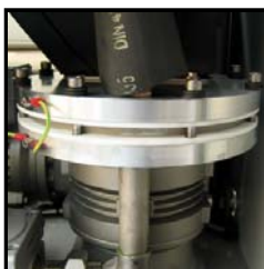
Verteilereinheit für pulsationsfreies Strahlen
