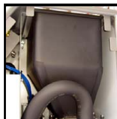
Isolierter Trockeneisbehälter mit einer Kapazität von 24 kg
