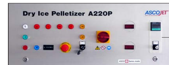
Steuerung für automatisches Füllsystem auf der Schalttafel
